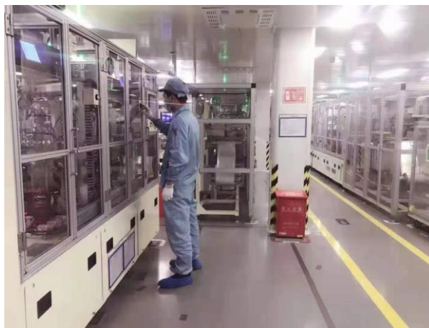
生产车间，无流水线，需要穿静电服
